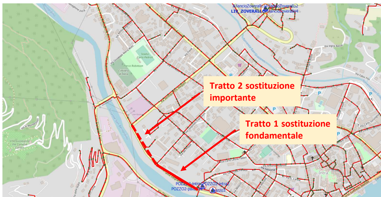
Figura 60 Indicazione planimetrica dei tratti di tubazione da sostituire per l'ottimizzazione della Zona Intra intermedia
