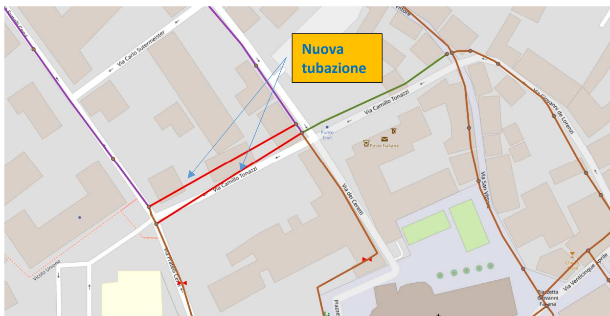
Figura 95 Inserimento di due nuove tubazioni DE 90 in HDPE in via Camillo Tonazzi
