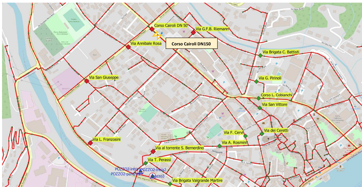
Figura 62 Ubicazione delle saracinesche da chiudere (oltre a quelle già chiuse per la formazione degli altri sub-distretti) e delle valvole regolatrici di pressione
