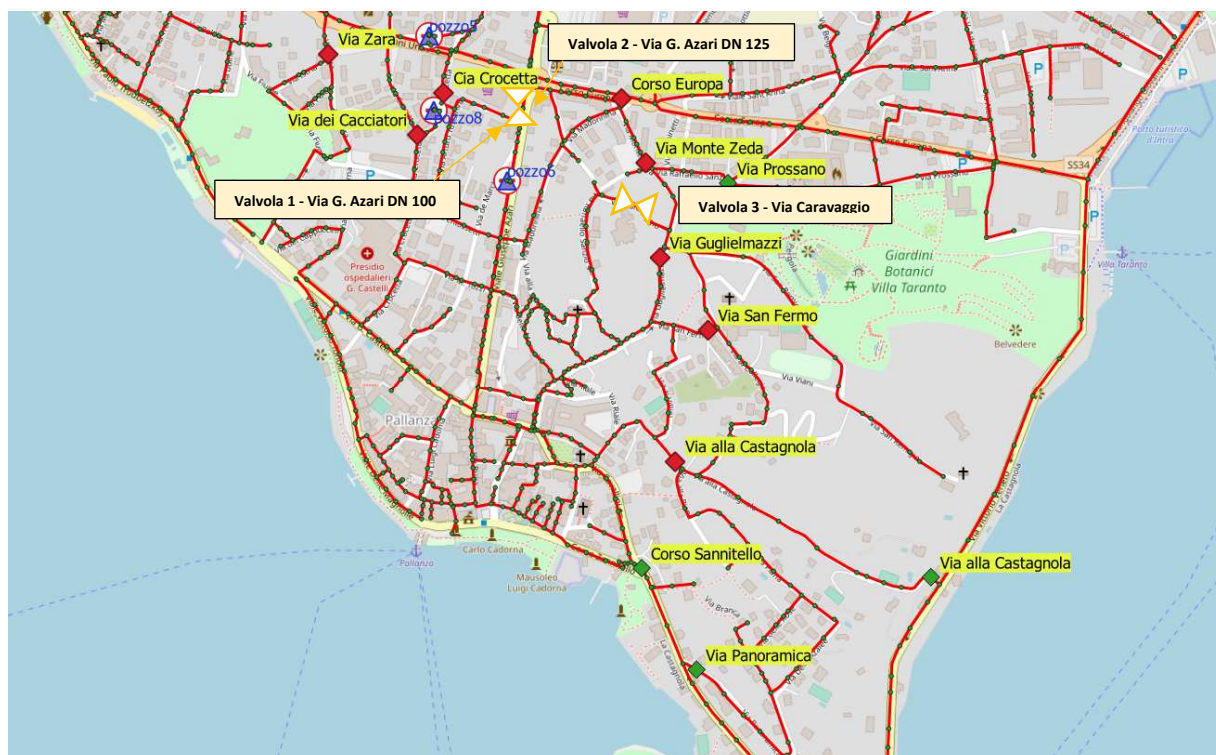
Figura 69 Ubicazione delle saracinesche da chiudere (oltre a quelle già chiuse per la formazione degli altri sub-distretti) e delle valvole regolatrici di pressione
