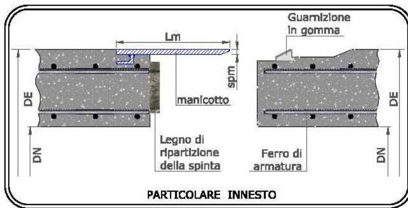
Figura 15 particolare innesto nel tratto di microtunnelling
