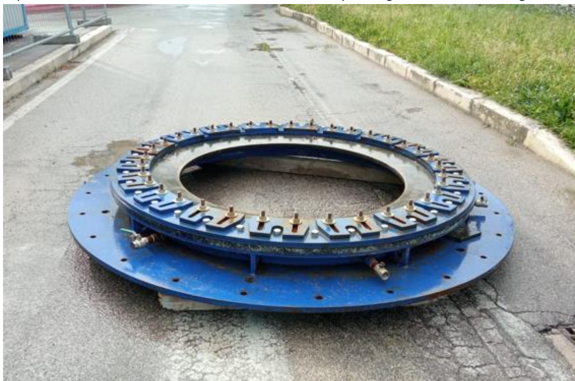
Figura 20 anello di tenuta da lasciare in opera
