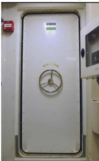
Figura 32 esempio di portellone stagno
