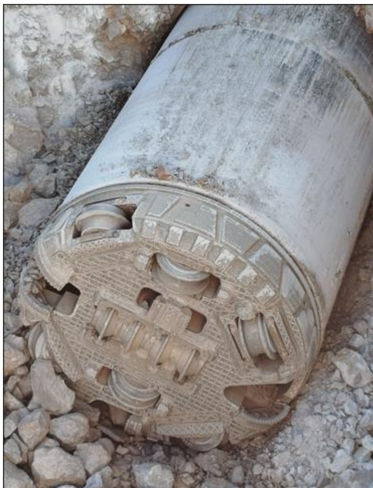
Figura 18 esempio di testa fresante da roccia
