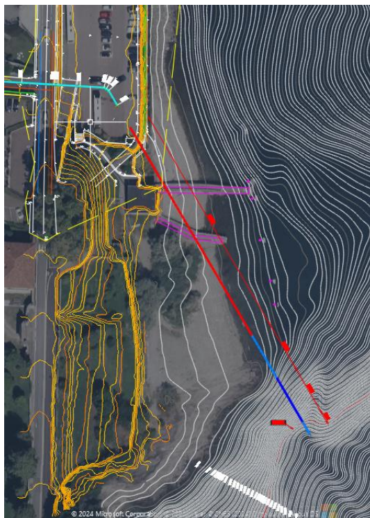
Figura 5 rilievo batimetrico con indicazione dell'andamento planimetrico della condotta in progetto
