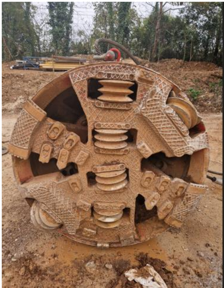
Figura 17 esempio di testa fresante
