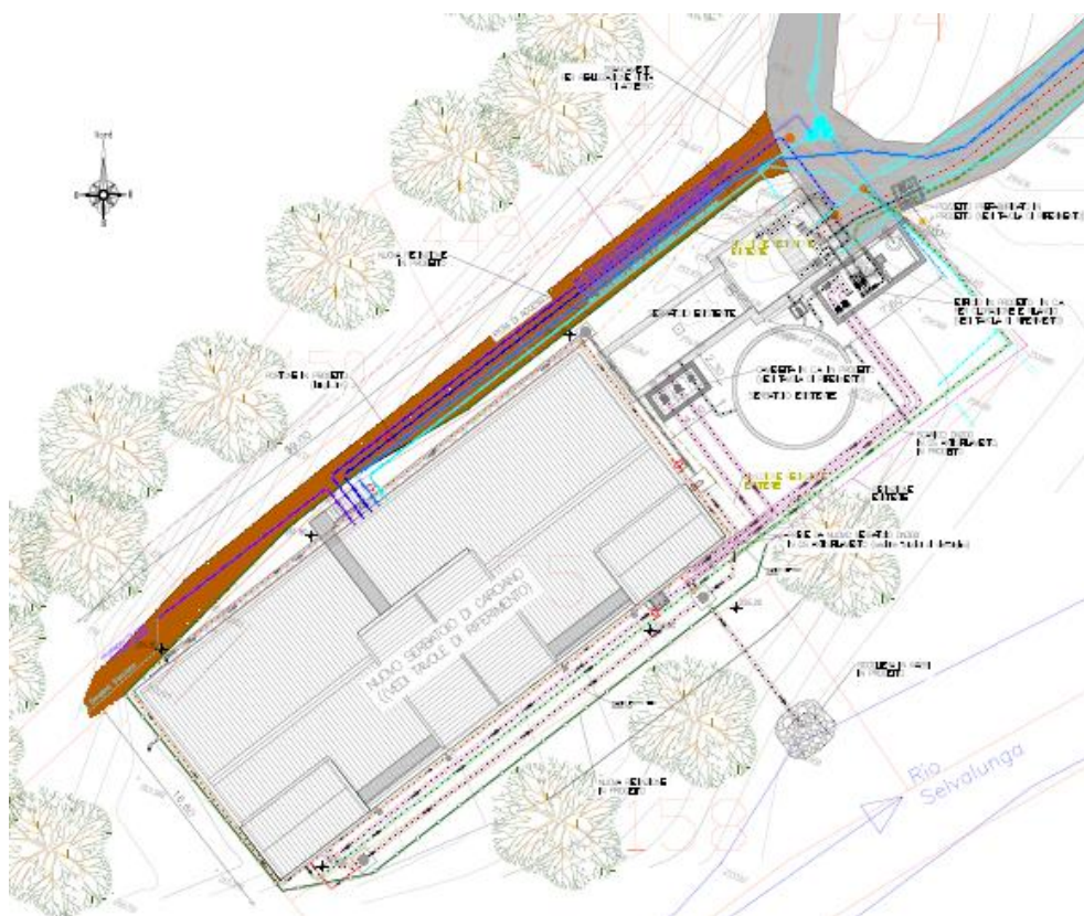
Figura 1: Estratto planimetria del nuovo serbatoio per acqua potabile in progetto in località Carciano del comune di Stresa
