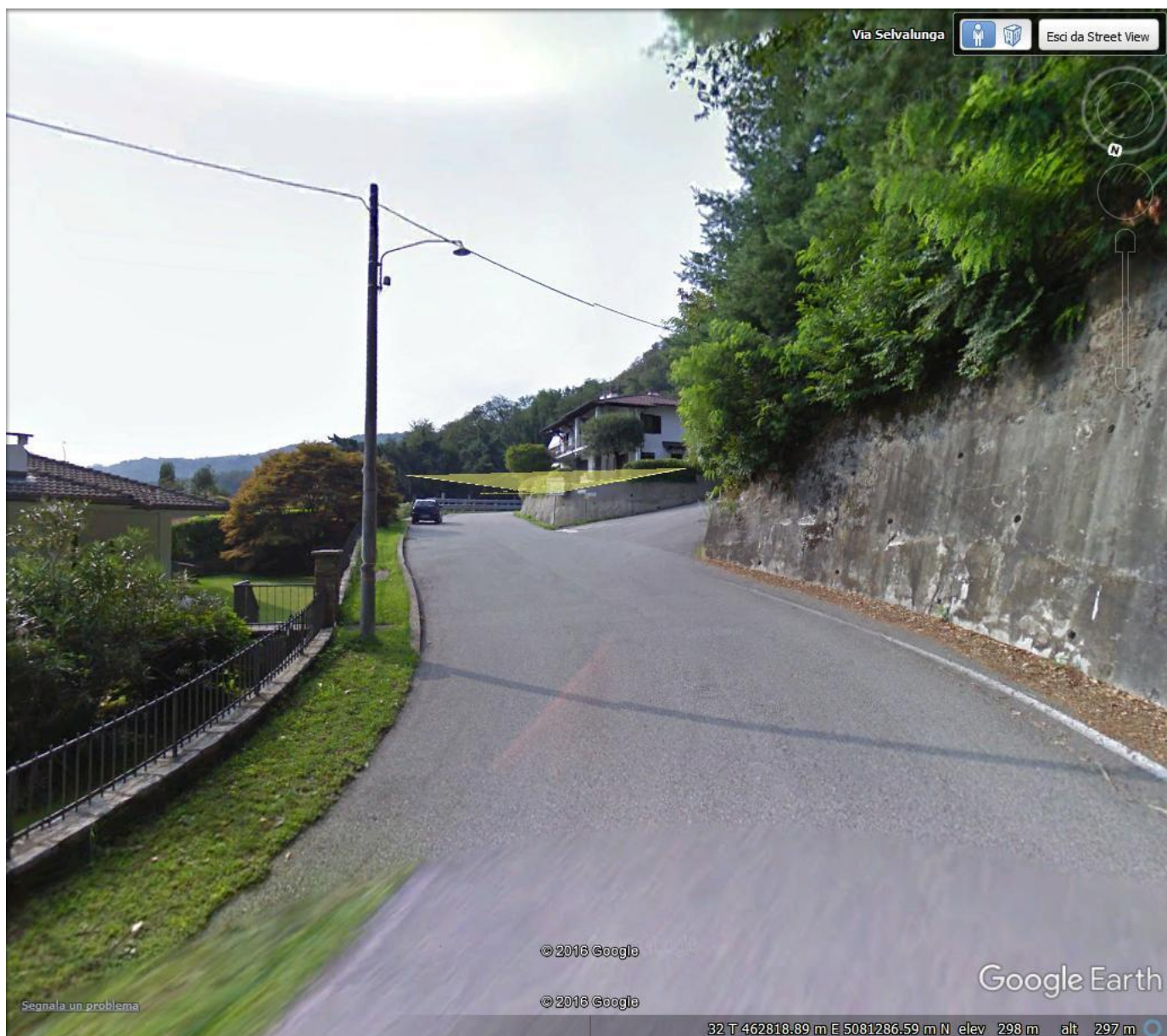
Foto 7) Via Selvalunga incrocio via per Stresa : interferenza con rete elettrica aerea.
