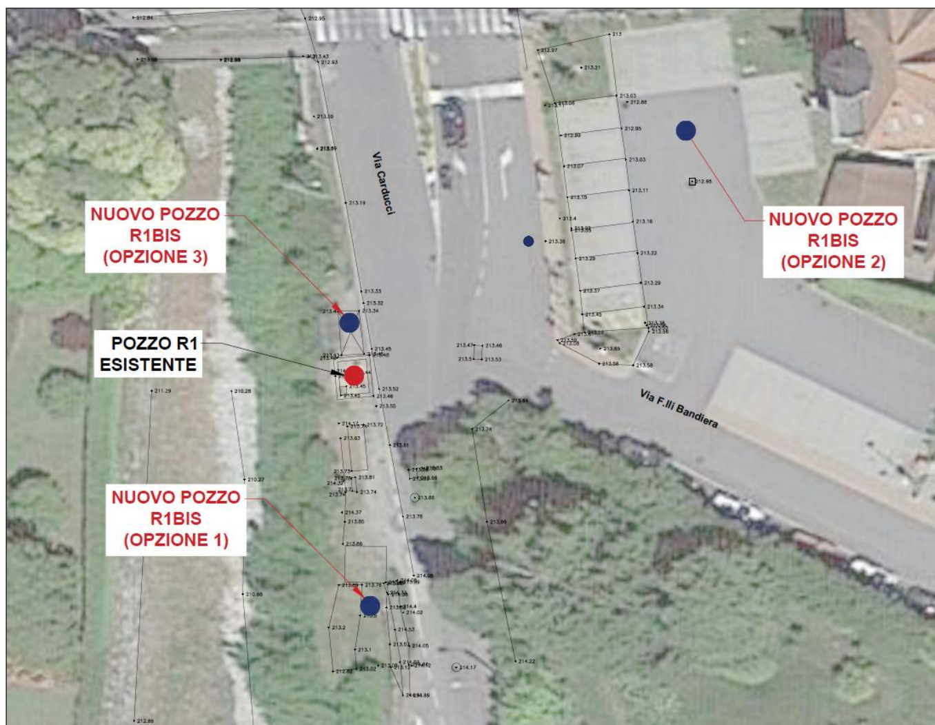
Figura 11 - Opzioni di localizzazione della riperforazione del pozzo Roddo 1, in comune di Stresa.
