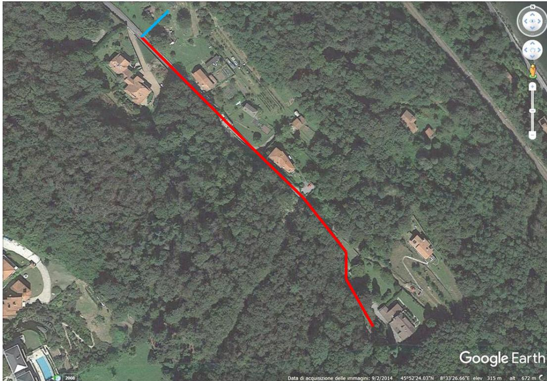
La soluzione per i pozzetti è necessaria a motivo della presenza nella via Lombartino di una rete meteorica in centro strada, che impedisce di inserire pozzetti di ispezione da 1 m di diametro per la condotta in progetto, in quanto non troverebbero fisicamente lo spazio necessario.
