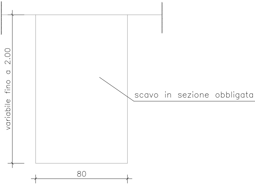
SEZIONE TIPO DI SCAVO scala 1:20
