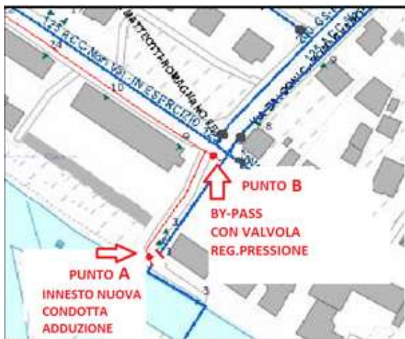
Figura 4 posizionamento della valvola di regolazione pressione
