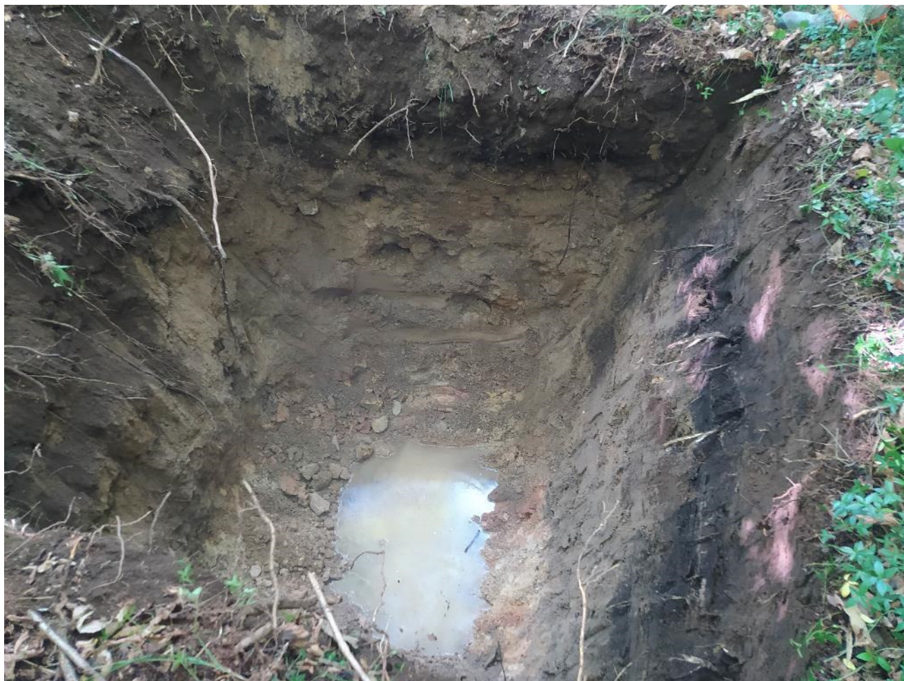
Fig. 9.1 – Fuoriuscita idrica all'interno sondaggio S2
