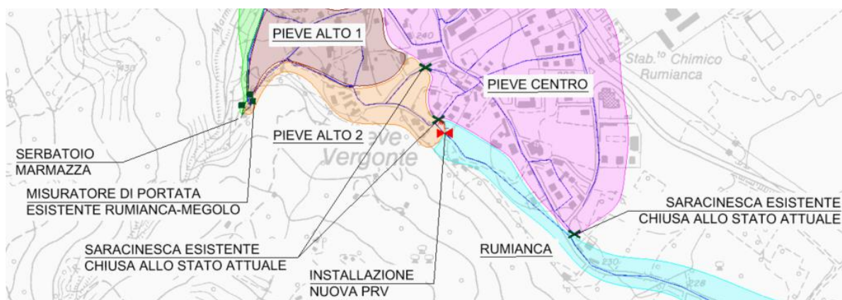
Figura 3 – Inquadramento distretto idrico Pieve Alto 2: installazione valvola PRV in Via Casella.
