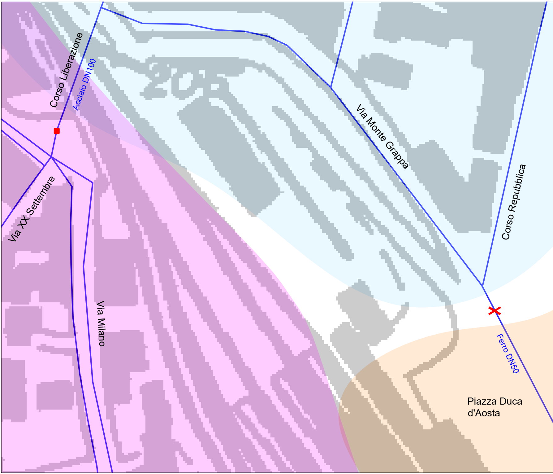
DETTAGLIO 6 Inserimento misuratore di portata in Corso della Liberazione e chiusura saracinesca in Via Monte Grappa Scala 1:1.000
