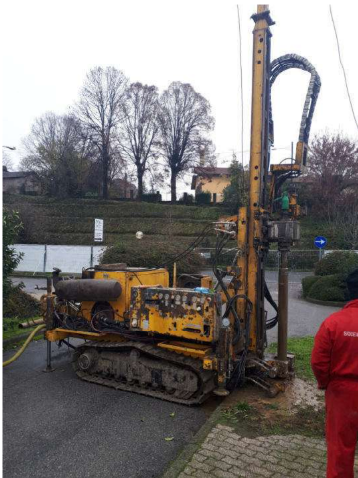
Foto n.11 Sonda con pompa triplex di portata 200 L, pressione continua 45 kg/cm 2 e pressione massima intermittente di 55 kg/cm 2
