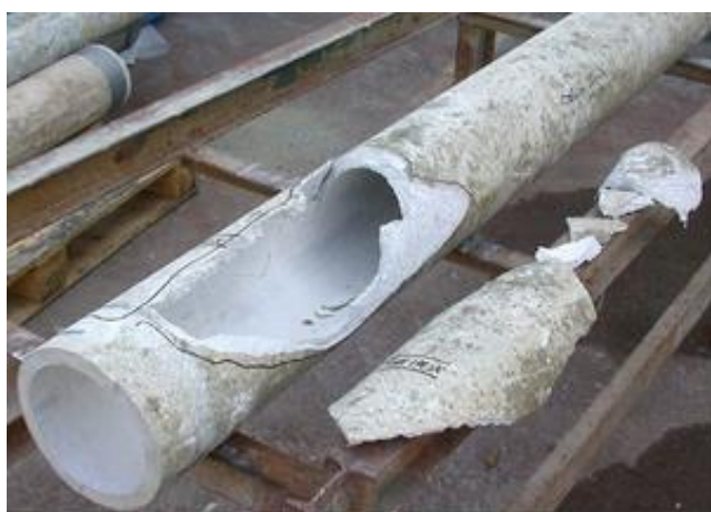
Tubazioni in cemento-amianto
