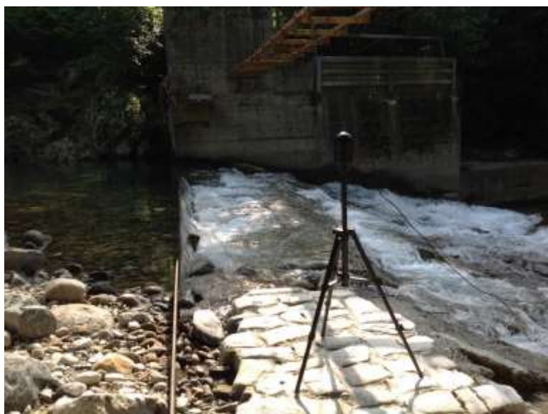
Figura 3 - rilievo mediante laser scan
