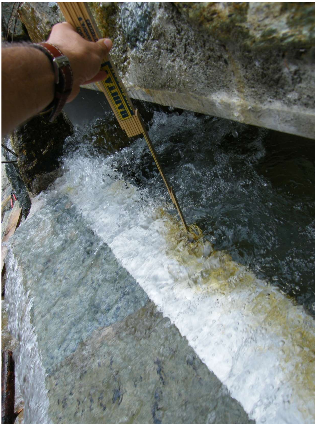
Figura 11 - misura altezza lama acqua su soglia rilascio DMV
