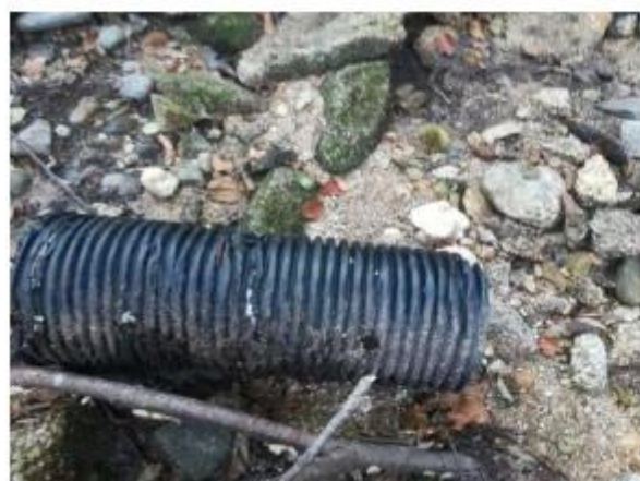
SPEZZONE DI TUBO IN PEAD RIGIDO FORATO A MANO
