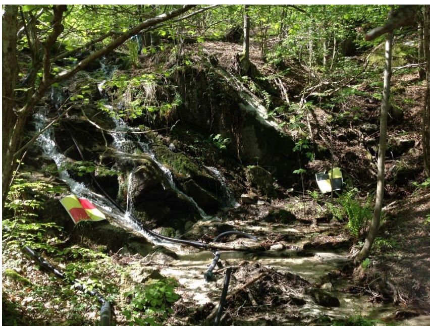
Figura 9 - rilievo mediante laser scan con target di riferimento
