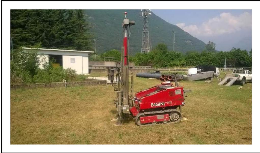
**Foto 7:** Postazione prova penetrometrica DPSH 1 bis.
