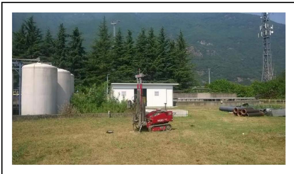
**Foto 6:** Postazione prova penetrometrica DPSH 1.
