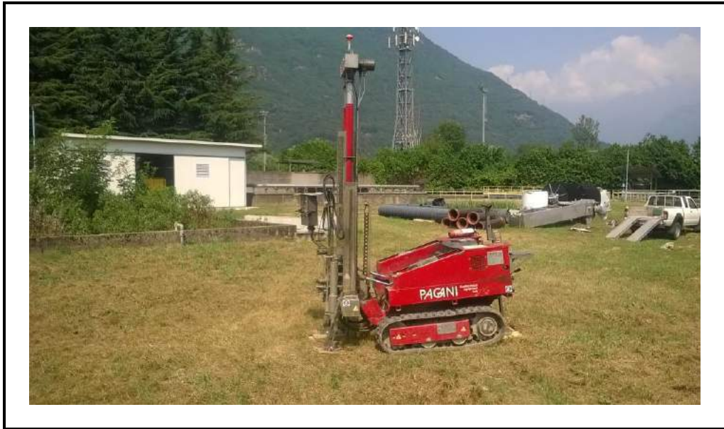
Foto 7: Postazione prova penetrometrica DPSH 1 bis.
