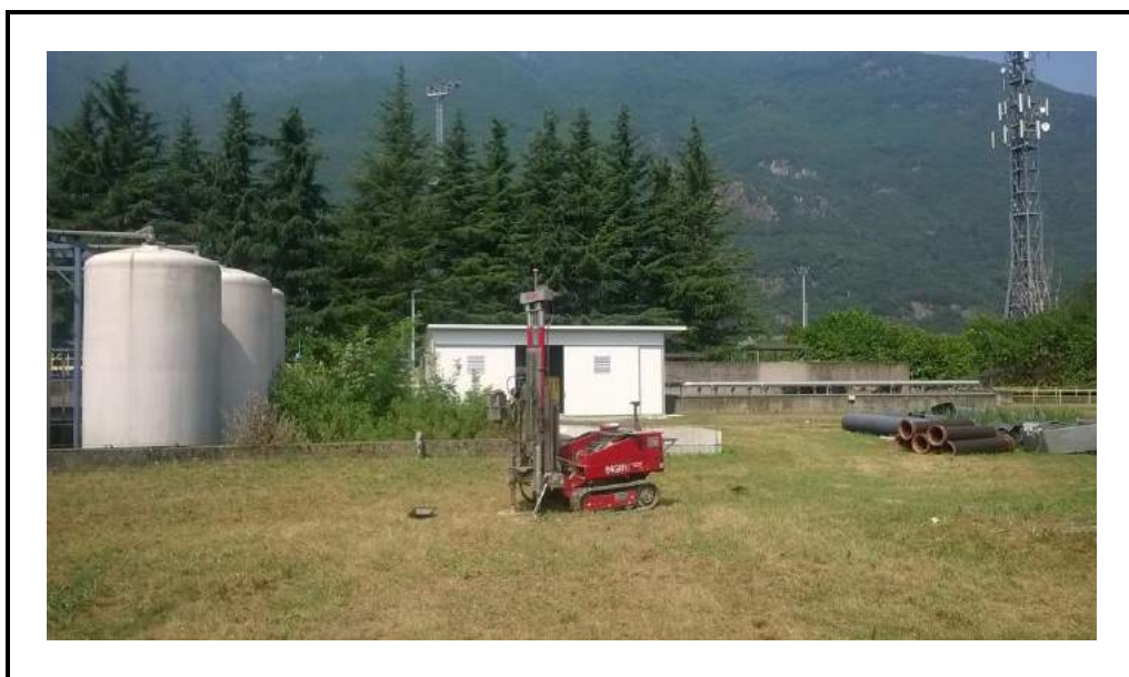
Foto 6: Postazione prova penetrometrica DPSH 1.
