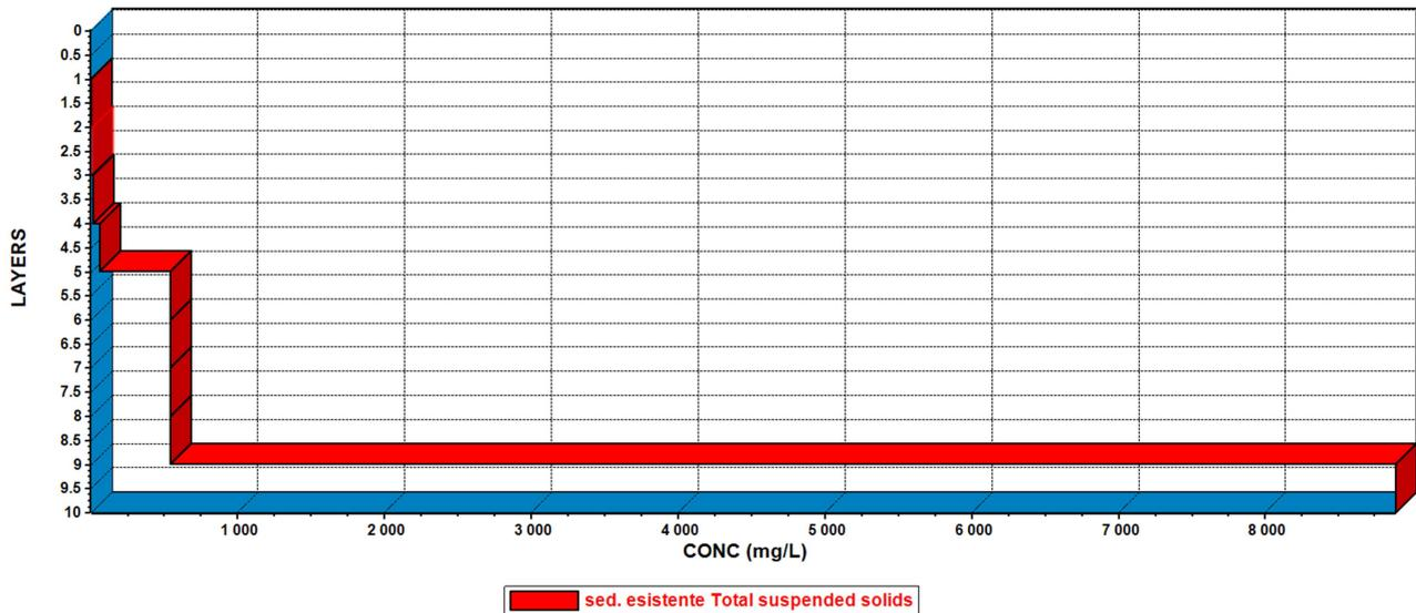
Esemplificazione strati di concentrazione di fango sul sed. II (altezza complessiva suddivisa in 10 strati da 25 cm), in basso la concentrazione di fango sul fondo sedimentatore)
