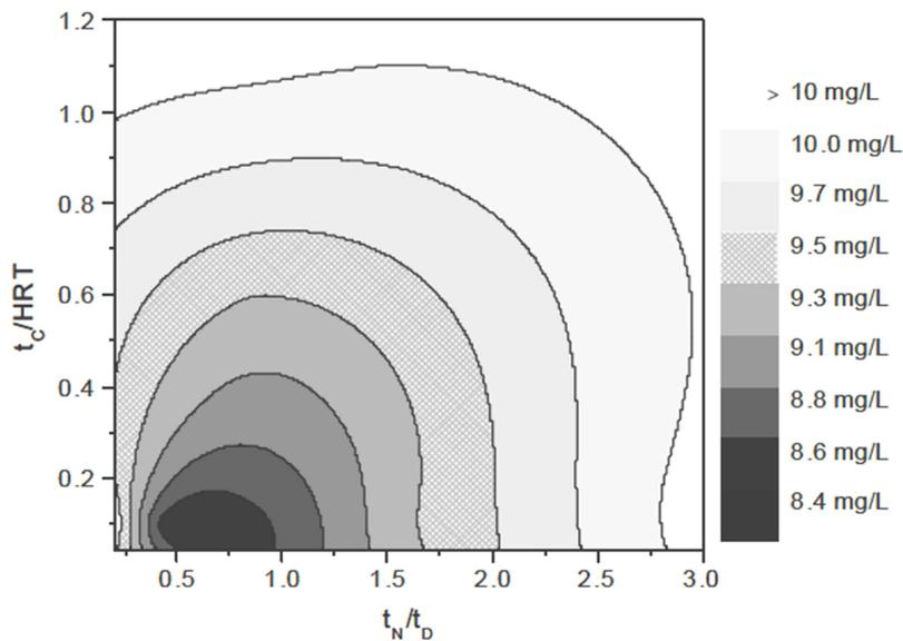
Concentrazione di Ntot nell'effluente in funzione di  $t_c/HRT$  e di  $t_n/t_d$ . Fissando ad es.  $t_c/HRT = 0,10$  (valore ottimale) si determina il valore di  $t_c = 0,1 \cdot HRT$
