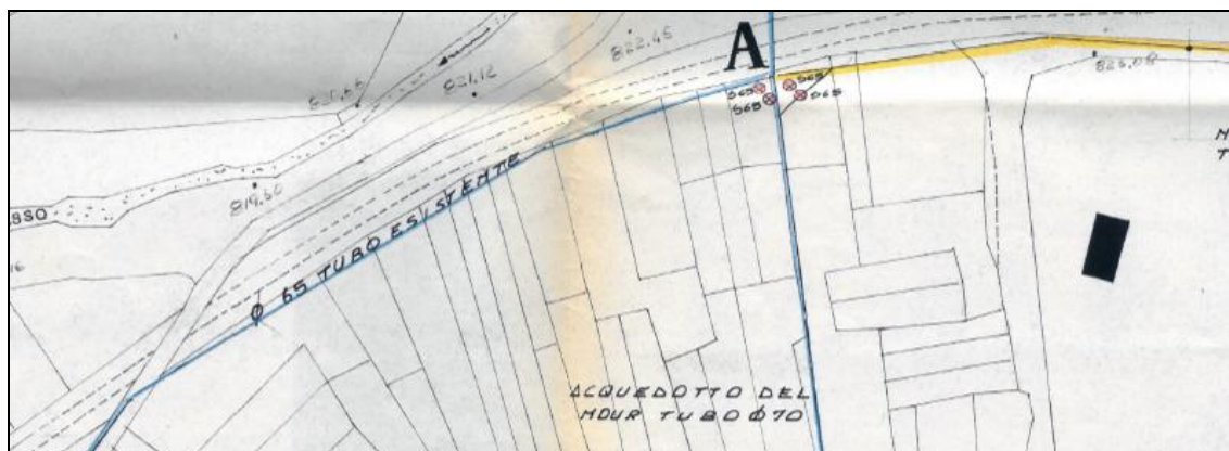
Figura 10 – Stralcio della tavola progettuale del 1979 nella quale il diametro della condotta proveniente dal Mour è indicato in 70 mm
