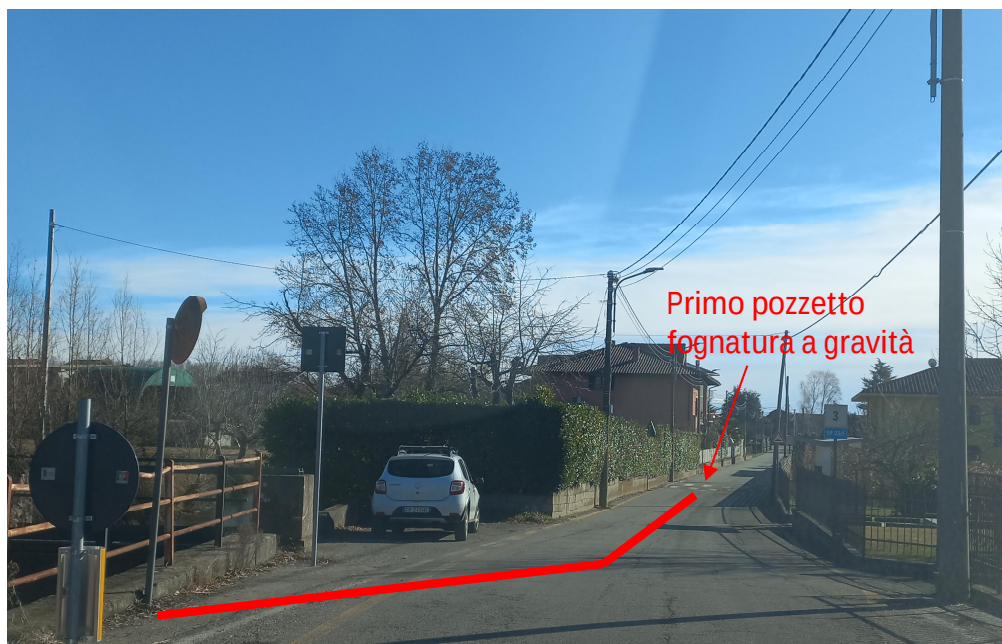
Foto 9: Tratto interrato di collegamento tubazione in pressione dopo ponte su Lirone a tubazione fognaria esistente su Via Salvemini.
