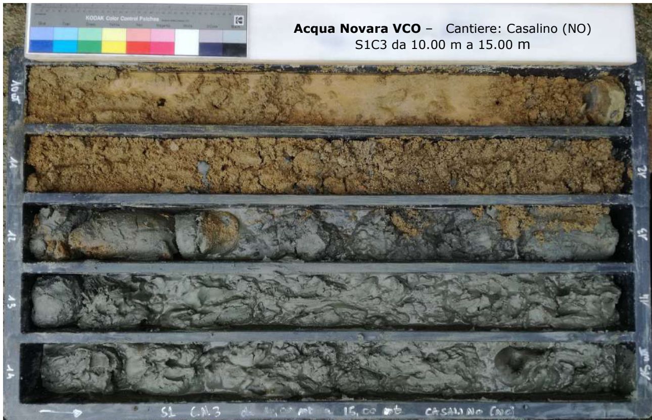
Foto 3. Sondaggio S1 da 10.00 m a 15.00 m
