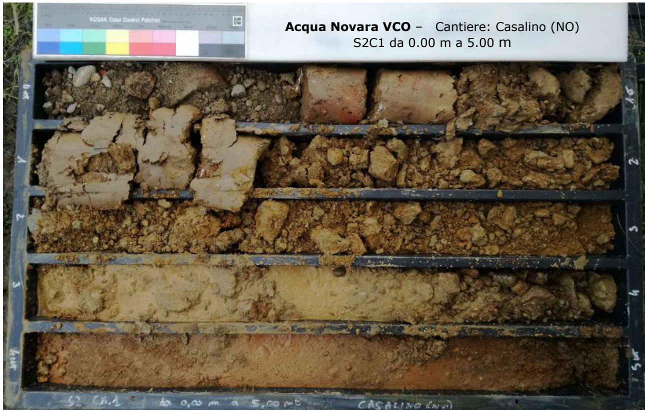
Foto 4. Sondaggio S2 da 0.00 m a 5.00 m
