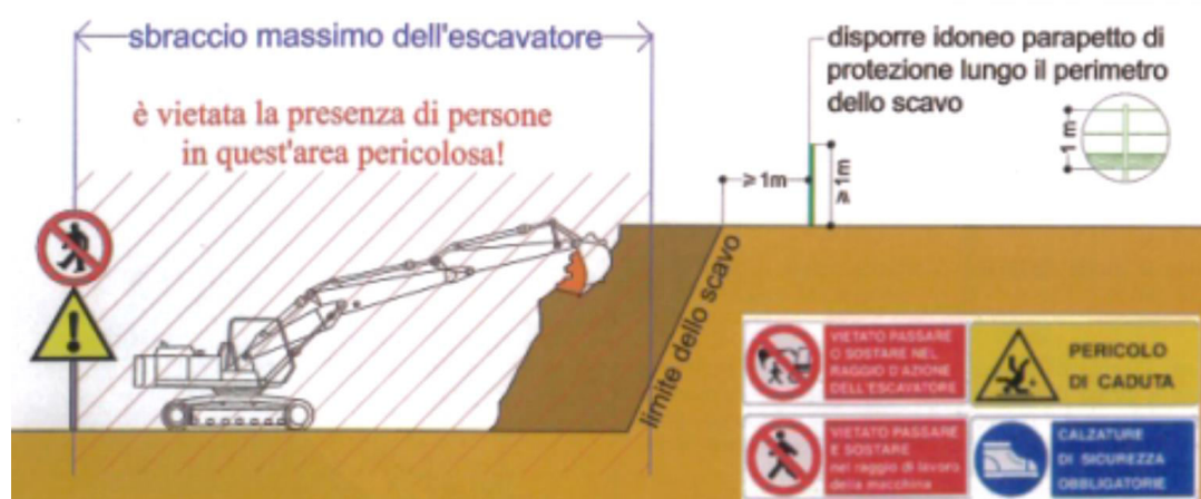
Figura 5: Modalità operative dei mezzi d'opera
