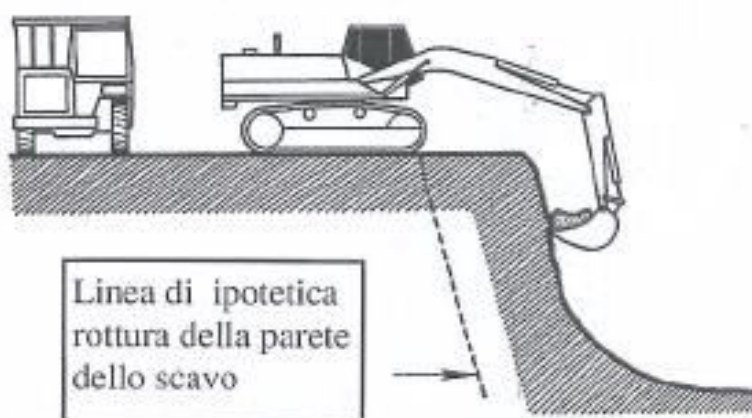
Figura 4: Posizionamento dei mezzi d'opera
