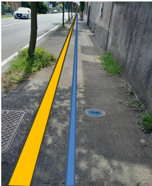
Figura 2 – reti preesistenti lungo la via oggetto di intervento (in giallo la rete meteorica e in azzurro la rete acquedotto).
