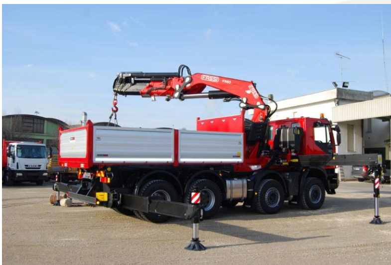
Figura 5: Autocarri con gru per la movimentazione dei carichi
